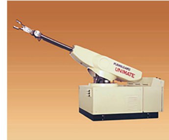
極座標型 旋回軸を中心にアームが上下に回転し、さらに伸縮する。
