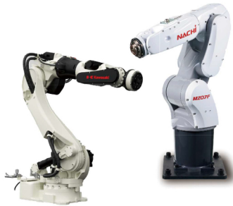
垂直多関節 複数の関節（軸）をもち、関節とリンクが垂直で直列に繋がり、アーム先端が垂直面内を広範囲に移動。
