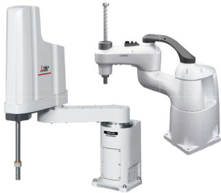
水平多関節 複数の関節（軸）をもち、関節とリンクが水平で直列に繋がり、アーム先端が水平面内を広範囲に移動。
