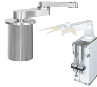
円筒座標 旋回軸を中心にアームが上下方向に移動し、さらに伸縮する。
